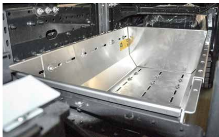
Raum optimal genutzt: Netzkästen zwischen den Achsen.
